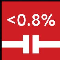
Wir legen großen Wert darauf, dass jeder von Audiovector ausgelieferte Lautsprecher den gleichen hohen Standards entspricht. Hierfür braucht man zum einen erfahrene Mitarbeiter in der Produktion (und keine Fertigungsstraßen) und zum anderen Bauteile, deren Werte möglichst wenig schwanken. Zum Beispiel haben unsere Frequenzweichen-Kondensatoren eine Toleranz von 0,8 % – was bedeutet, dass jeder einzelne Audiovector-Lautsprecher klanglich identisch mit seinen Schwesternmodellen ist.
