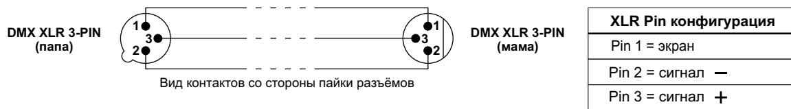
Используйте только специальный цифровой экранированный кабель и качественные 3-х контактные разъёмы XLR для подключения приборов в линию DMX-512 и соединения между собой.
