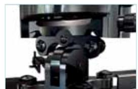
Полная регулировка по всем осям, наклон на +/-25°, поворот на +/-6°, вращение на 360°
