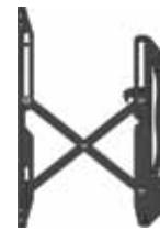
Выдвигается на 27 см от стены для технического обслуживания
