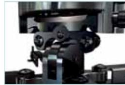
Полная регулировка по всем осям, наклон на +/-25°, поворот на +/-6°, вращение на 360°
