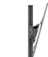
Наклон в диапазоне +15°/-5° дает оптимальный угол обзора
